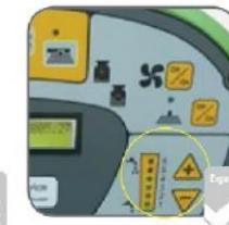
دارای دشانگر میزان روش آب در روی سطح
