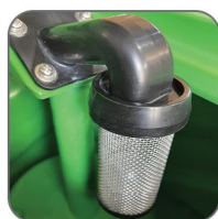
مجهز به شناور قطع کن مجرای مکش که در زمان پر شدن مخزن آب کثیف سبب جلوگیری از ورود آب داخل موتور و در نهایت پوسیدگی آن می گردد.
