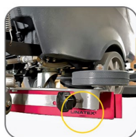
استفاده از لاستیک های تی ساخت کمپانی linatex جهت افزایش کارایی و سطح کیفی خشک کنی.
