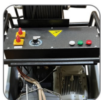
دارای صفحه فرمان و تابلو برق، مجهز به سیستم های حفاظتی در برابر نوسانات برق
