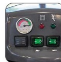
دارای بارومتر با فشارسنج، جهت نمایش و اعلام فشار وارده بر موتور
