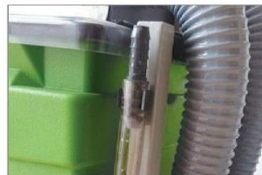
دارای نشانگر سطح آب در داخل مخزن آب تمیز
