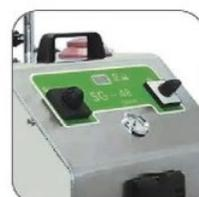
مجهز به نمایشگر دیجیتال درجه حرارت بخار خروجی و آمادگی دستگاه جهت شروع کار
