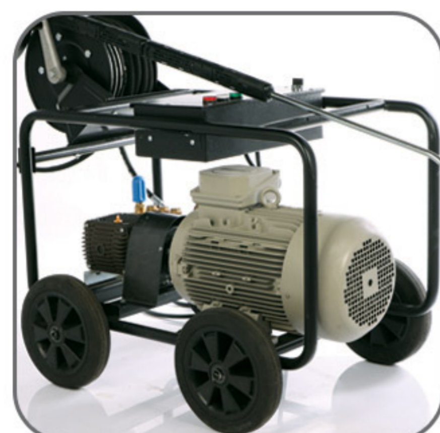
دارای شاسی چهار چرخ جهت افزایش ایستایی دستگاه و جلوگیری از لغزش های احتمالی
