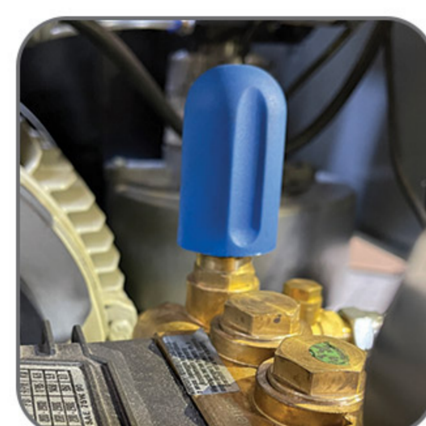
دارای پیچ تنظیم فشار خروی جهت کم و یا زیاد کردن فشار آب خروجی
