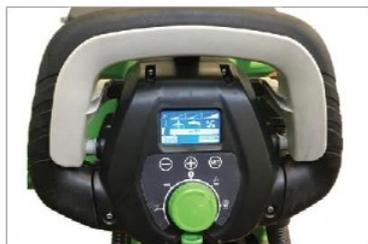
مجهز به نمایشگر میزان شارژ باطری، شمارشگر ساعت کاری دستگاه و مجهز به سیستم تشخیص عیب و اعلام وضعیت فنی دستگاه به صورت کد ۳ رقمی
